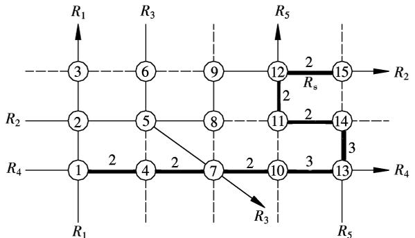
图 3 Dijkstra 算法最短路径方案图
